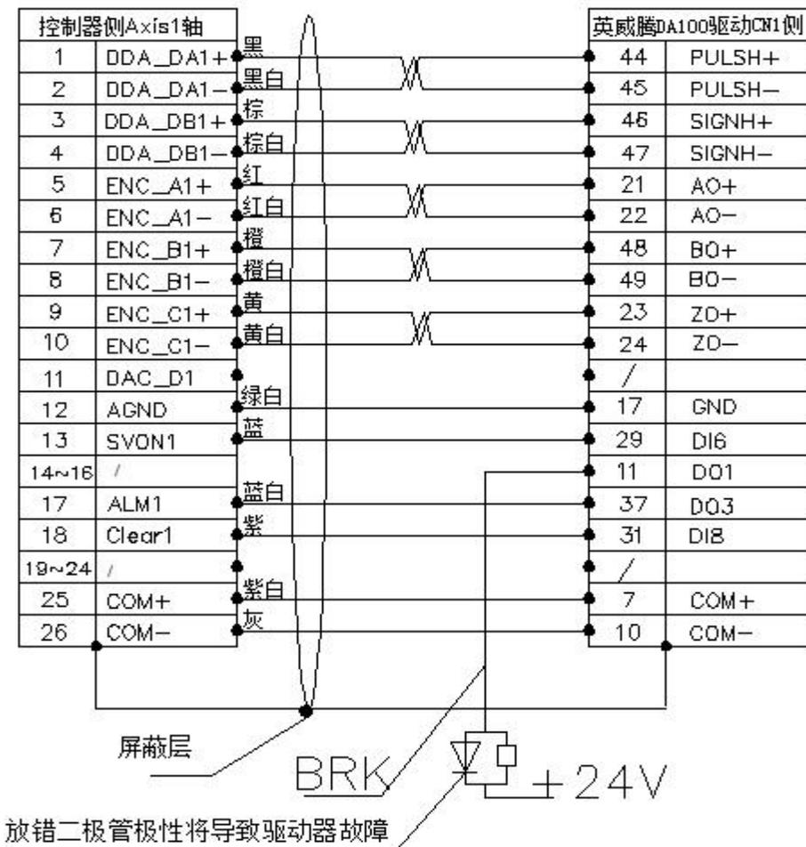
备注：系统到驱动器连接要求采用双绞 2\*8 屏蔽电缆,抱闸系统电缆采用 1\*2 屏蔽线连接到抱闸制动板上，外壳要与屏蔽层连接良好。控制器侧的 AGND 必须跟伺服的 GND 连接，否则会造成控制器硬件严重损坏。
