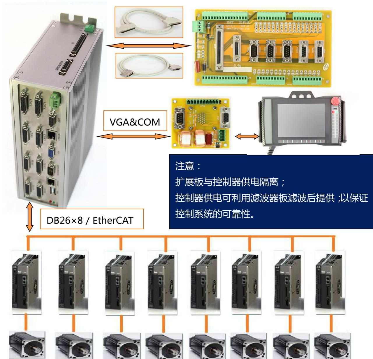
图 2.1- 2 Alone ( AMC+VGA ) 模式基本配置示意图
