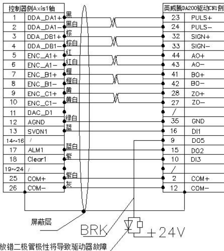
备注：系统到驱动器连接要求采用双绞 2\*8 屏蔽电缆,抱闸系统电缆采用 1\*2 屏蔽线连接到抱闸制动板上，外壳要与屏蔽层连接良好。控制器侧的 AGND 必须跟伺服的 GND 连接，否则会造成控制器硬件严重损坏。
