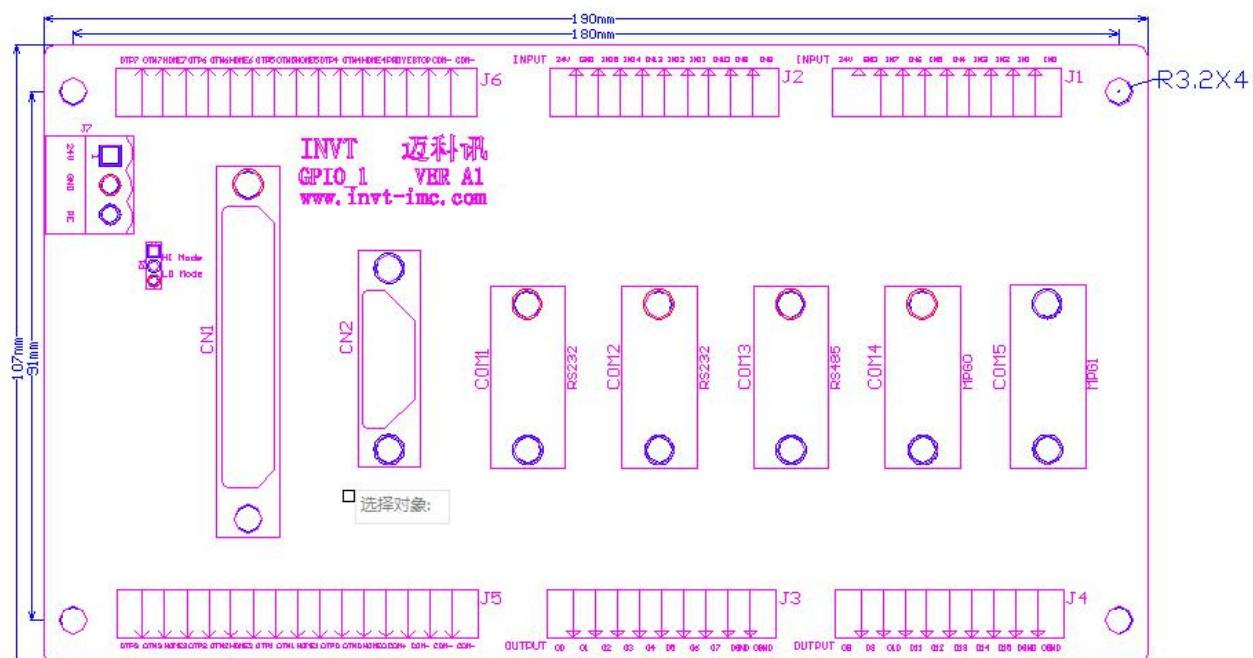
图表 4.4- 4 转接板尺寸图
