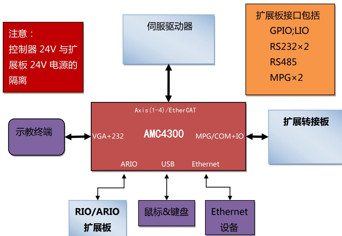
图表 2.1- 1 Alone 模式结构示意图
