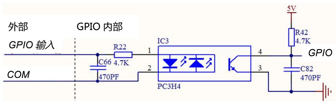
图表 4.4- 3 GPIO 输入电路
