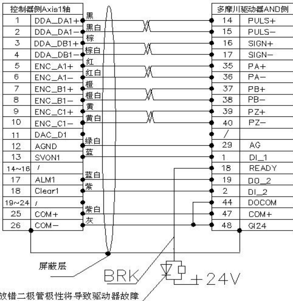
备注：系统到驱动器连接要求采用双绞 2\*8 屏蔽电缆，抱闸系统电缆采用 1\*2 屏蔽线连接到抱闸制动板上，外壳要与屏蔽层连接良好。控制器侧的 AGND 必须跟伺服的 GND 连接，否则会造成控制器硬件严重损坏。抱闸输出线需客户自行设置，具体联系方法可参考其他伺服连线。
