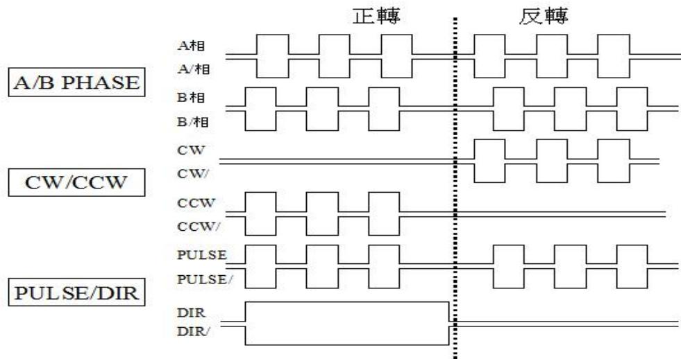
图表 2.2-3 输出脉冲格式示意图
