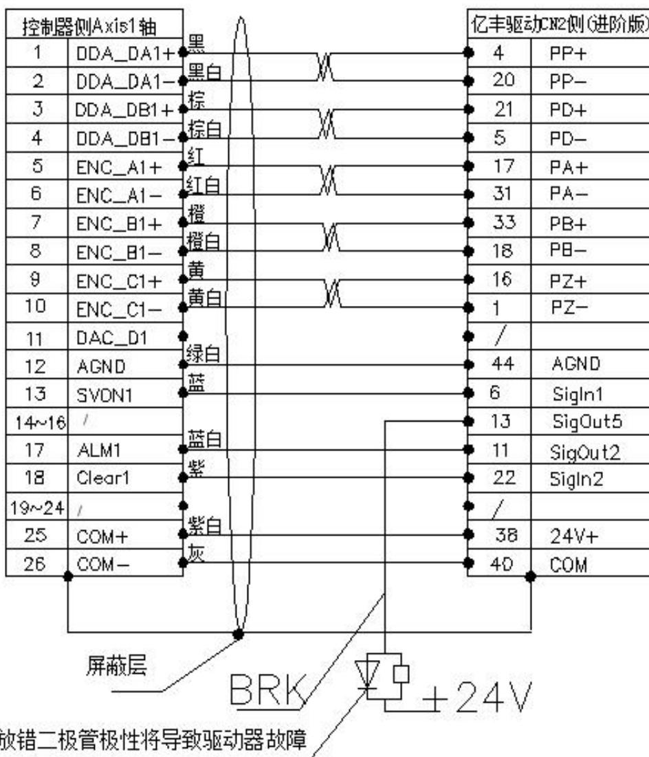
备注：系统到驱动器连接要求采用双绞 2\*8 屏蔽电缆，抱闸系统电缆采用 1\*2 屏蔽线连接到抱闸制动板上，外壳要与屏蔽层连接良好。控制器侧的 AGND 必须跟伺服的 GND 连接，否则会造成控制器硬件严重损坏。
