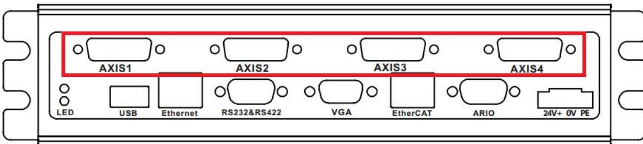
如图所示，红的框内为轴控信号接口，详细引脚说明见表格 4.2- 2 DB26 引脚定义。
