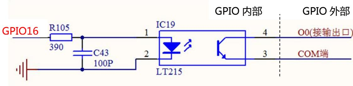
图表 4.4- 2 GPIO 输出电路
