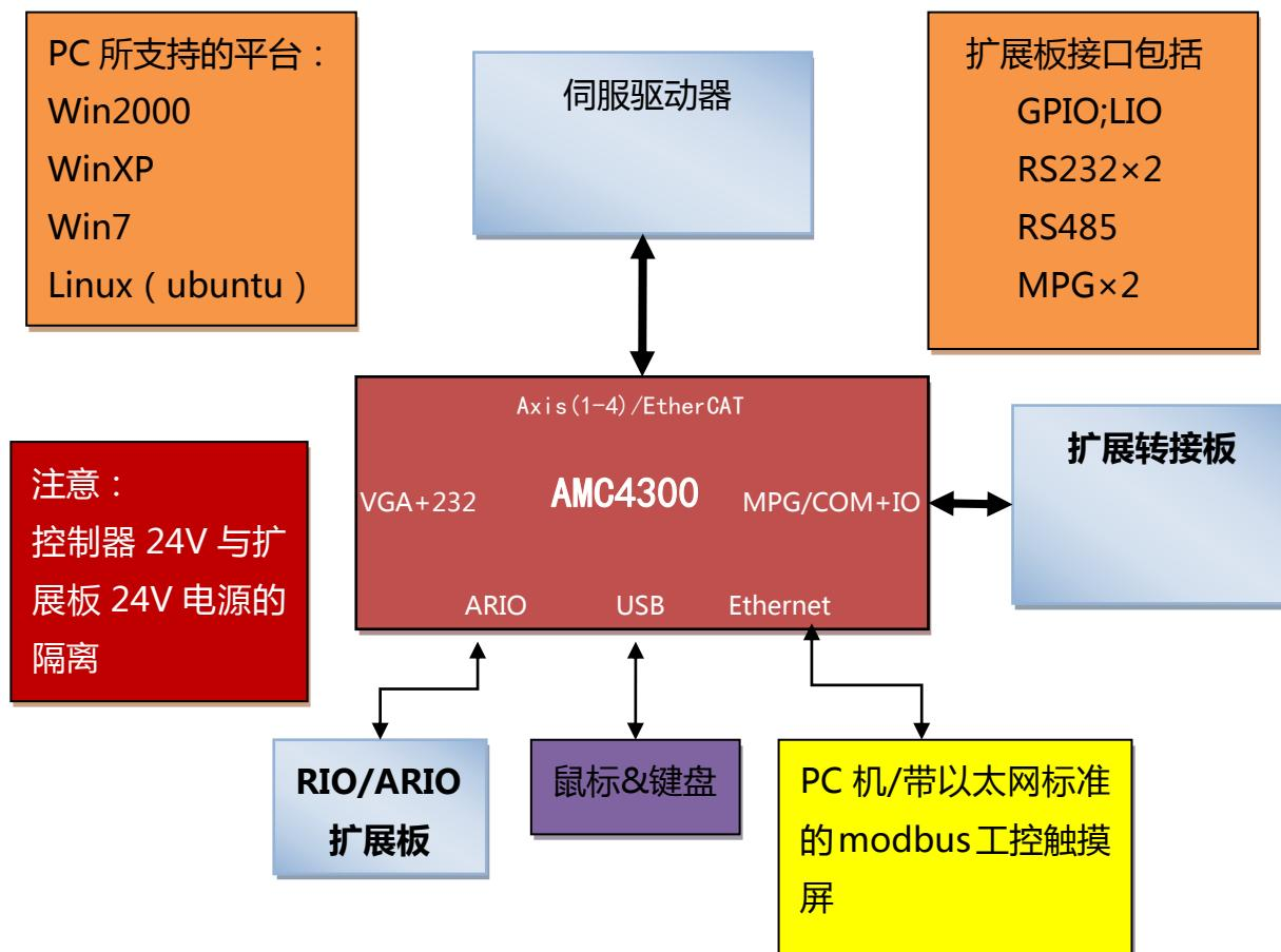
图 2.1- 3 A+PC 控制模式结构图
