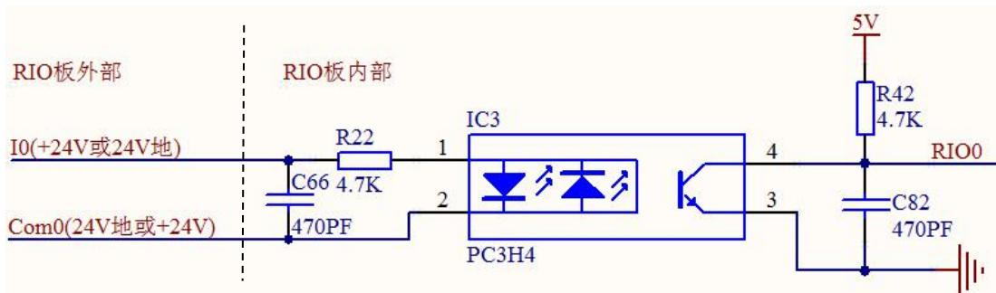
图表 4.5-1 ARI0 输入电路
