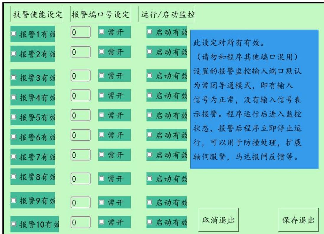
程序运行中,系统会对所设定的报警输入端口做实时监控,如果有输入信号表示作业正常,没有输入信号则停止当前运行程序,并报警。
