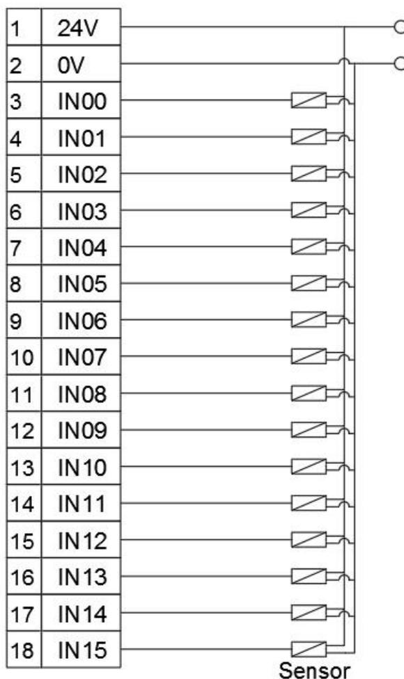
图 4.2.3 INPUT 输入端口接线示意图
