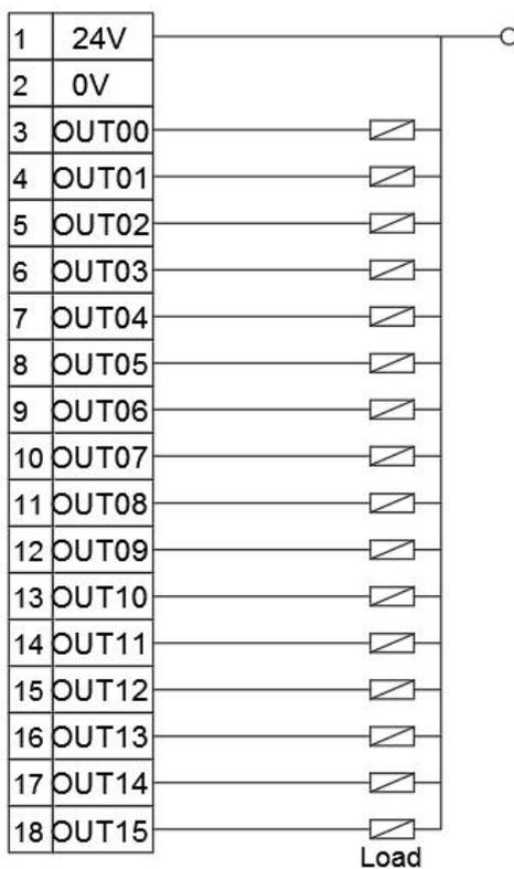
图 4.2.5 OUTPUT 输出端口接线示意图
