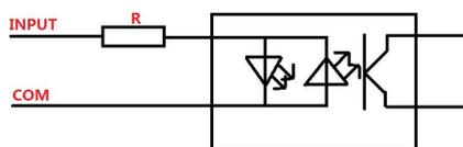
图 4.2.2 GOIO 输入电路示意图
