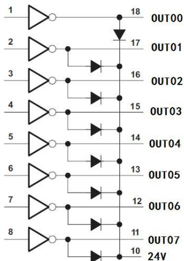
图 4.2.4 GPIO 输出电路示意图
