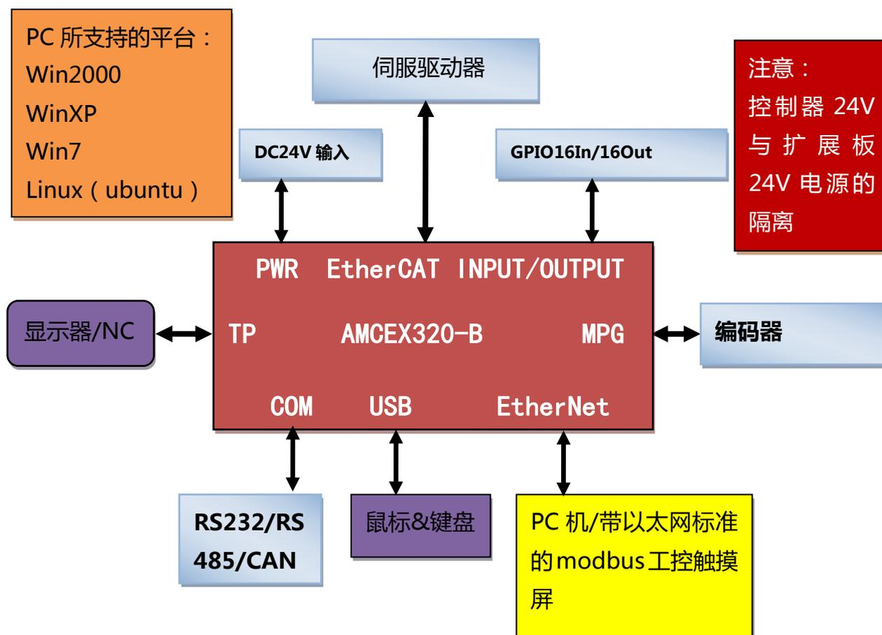
图 2.1.2 A+PC 控制模式结构图
